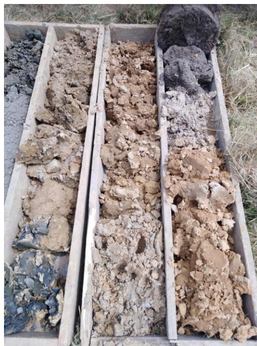
Obrázek 3, 4 - Geologický profil vrtu J-1 – detail
