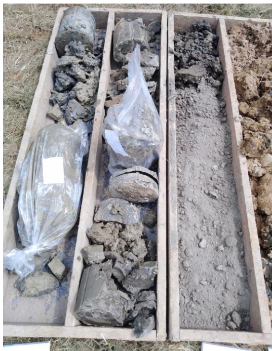
Obrázek 3, 4 - Geologický profil vrtu J-1 – detail
