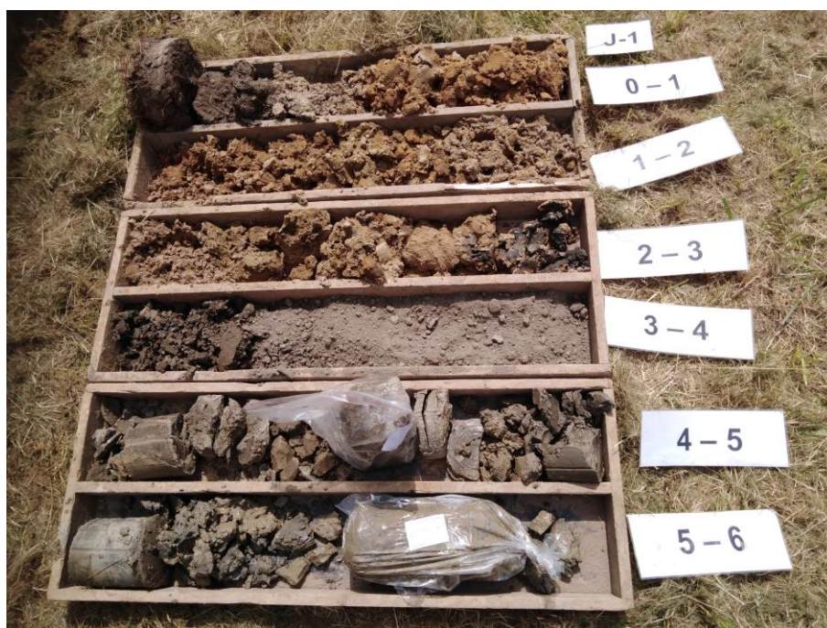
Obrázek 2 – Geologický profil vrtu J-1
